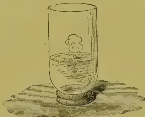
Fig. 202. Combustione del sodio nell'acqua.
